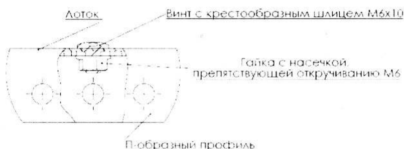
Рисунок 53 - Крепление лотков к профилю (консоли).
